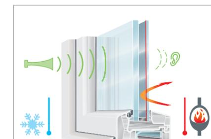
Isolation acoustique et thermique avec un double vitrage dissymétrique ou feuilleté acoustique
