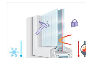
Vitrage de sécurité avec isolation thermique
