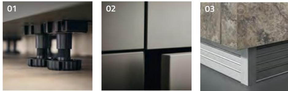
01. Le positionnement des pieds de socle peut être ajusté si nécessaire. Réglage en hauteur : +18/-10 mm.
